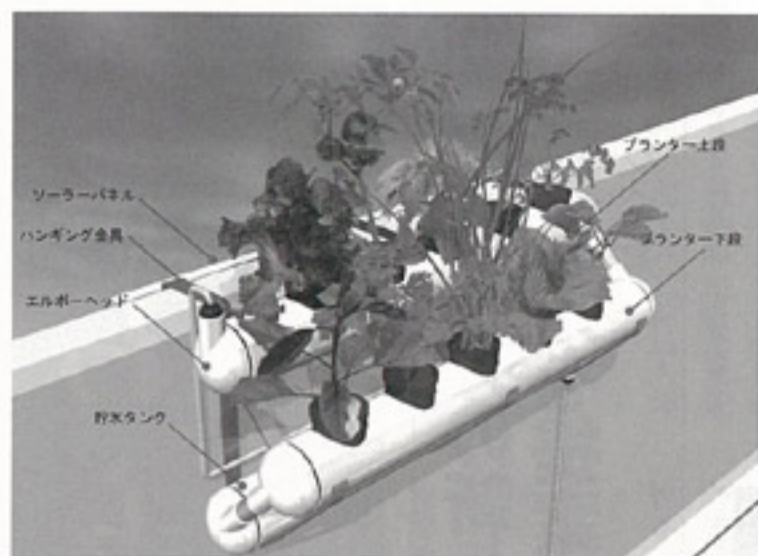
ソーラーパネル等の電源でプランター内の水を循環させる
